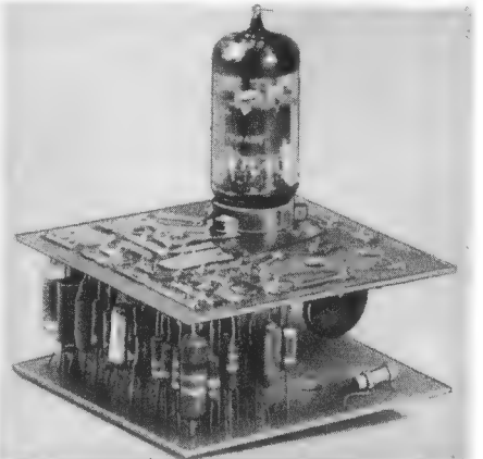
Bild 2. Weitere Volumenverringern durch Unterbringen der Einzelteile in mehreren Reihen
